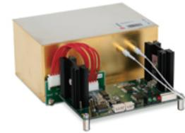
超長距離通信において使用されるモジュールです。光ファイバを伝わる信号の揺らぎを抑制し、伝送品質を向上させるものです。
