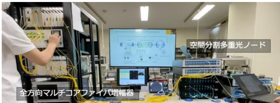
図 1 非対称データ通信を効率的に収容可能な空間分割多重光ネットワークの実験構成
