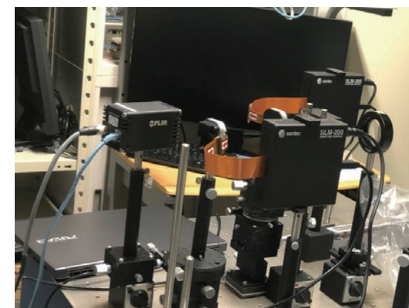
santec の SLM-200 を同時に 2 台使って、光の振幅と位相を制御する光学系。これによりホログラムテレビを作れるようになるという。
