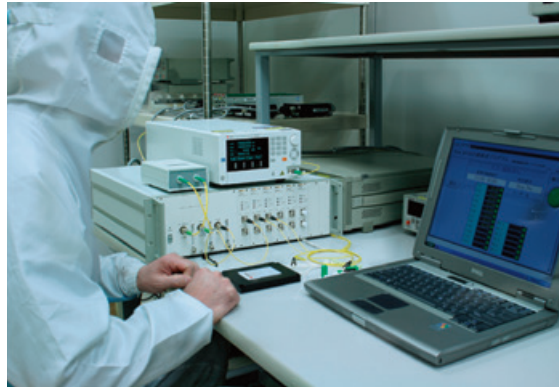
光部品製造工程を支える波長可変光源
